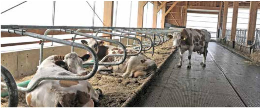
**DURCH DIE BEGRENZUNG** der Liegebucht an allen vier Seiten wird die Kuh beim Abliegen systematisch in eine optimale Liegeposition geführt. Ein weiterer entscheidender Vorteil der Betonmulde ist die bessere Matratzenbildung. Ideal ist ein Gemisch aus Stroh und kohlensaurem Kalk. Hohe Liegezeiten und beste Hygiene sind das Resultat.
