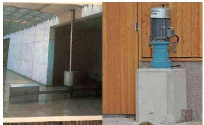
**SPEZIELLE GRUBENLÖSUNG:** Das Axialrührwerk von Odermatt stellt sich problemlos den Herausforderungen einer rechteckigen Güllegrube, die sich zur Hälfte unter dem Stallgebäude befindet. Das Paddelrührwerk hat einen Durchmesser von 5,20 m. Bei erhöhter Montage des Rührwerk-Antriebes sind das Getriebe, der 18-kW-Motor und die elektrischen Anschlüsse geschützt.
