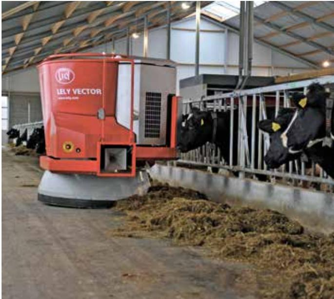
**DER LELY VECTOR** füttert Ihre Tier selbstständig und autonom, auf Bedarf in Gruppen und der Leistung angepasst.
