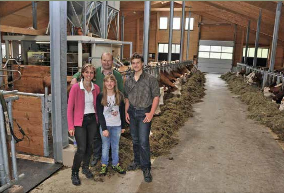
**HOLZ SCHAFFT RAUMKLIMA** und die Zimmerei Rohrmoser setzte die Ideen um: Die Halle ist eine Holzkonstruktion mit Leimbindern und 12-cm-Vollholzplatten, eingedeckt mit Tondach-Ziegeln. Die Wände sind aus 9 cm starken KLH-Platten mit Deckbrettschalung in Lärche sägerau gebürstet. Talseitig wurden Schiebefenster eingebaut, bergseitig die alten Hausfenster.
