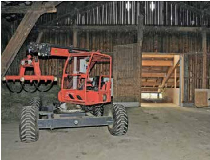
**DAS FUTTER** wird im alten Stallgebäude im Obergeschoß gelagert und gerichtet, das ist gerade im Winter bei Schnee und Kälte sehr komfortabel. Mit dem Ausleger des Mobilkranes werden die einzelnen Komponenten der TMR über die Holzbrücke direkt in den elektrischen Mischwagen geschoben und verteilt. Die Stromversorgung läuft über ein Kabel, das an einem Drahtseil geführt wird.
